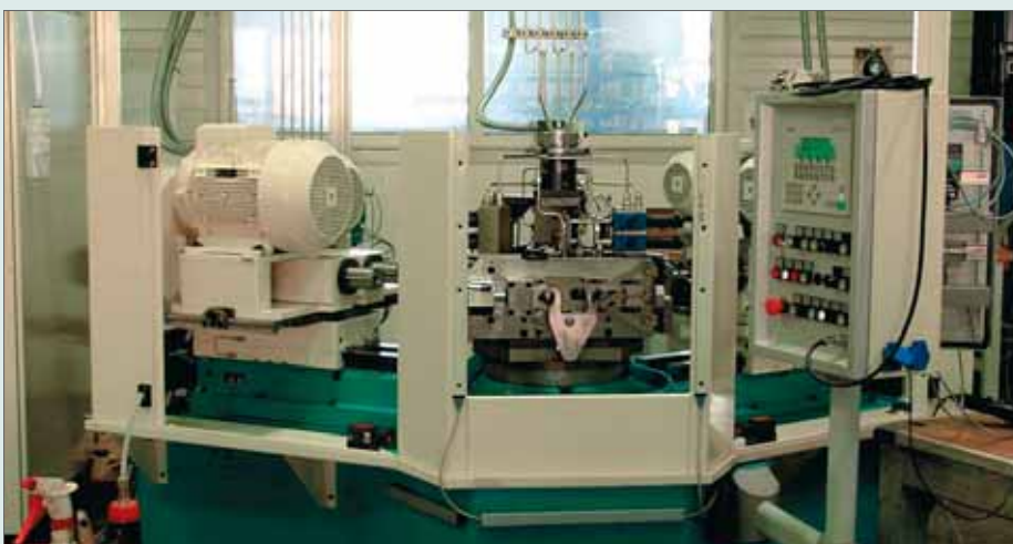
Generalüberholung und Modernisierung einer Rundtakttisch-Mehrspindelbohrmaschine
