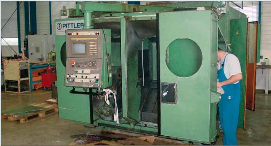
Generalüberholung und Modernisierung einer Doppelspindeldrehmaschine Maschine bei der Anlieferung bei GST
