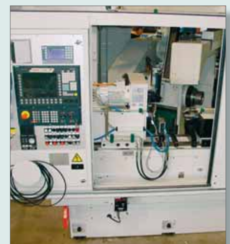
Generalüberholung und Modernisierung einer Rundschleifmaschine / General overhaul and modernization of a cylindrical grinder
