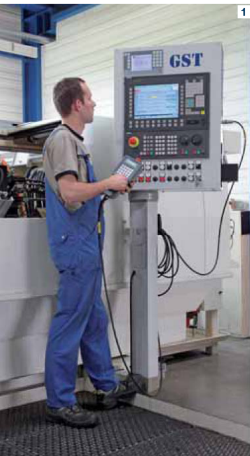
1 Herzstück der Automatisierungslösung ist eine SINUMERIK 840D Solution Line, deren offenes HMI-System die einfache Einbindung eigener Bilder zur Variableneingabe ermöglichte. 2 „Neben der SINUMERIK 840D Solution Line als CNC-Steuerung sind die SINAMICS S120 Antriebe für die Effizienzsteigerung der Maschinen verantwortlich“, bestätigt Günter Hacker, Geschäftsführer der GST Gesellschaft für Schleiftechnik GmbH. 3 Die Integration schließt auch Safety Integrated mit ein.
